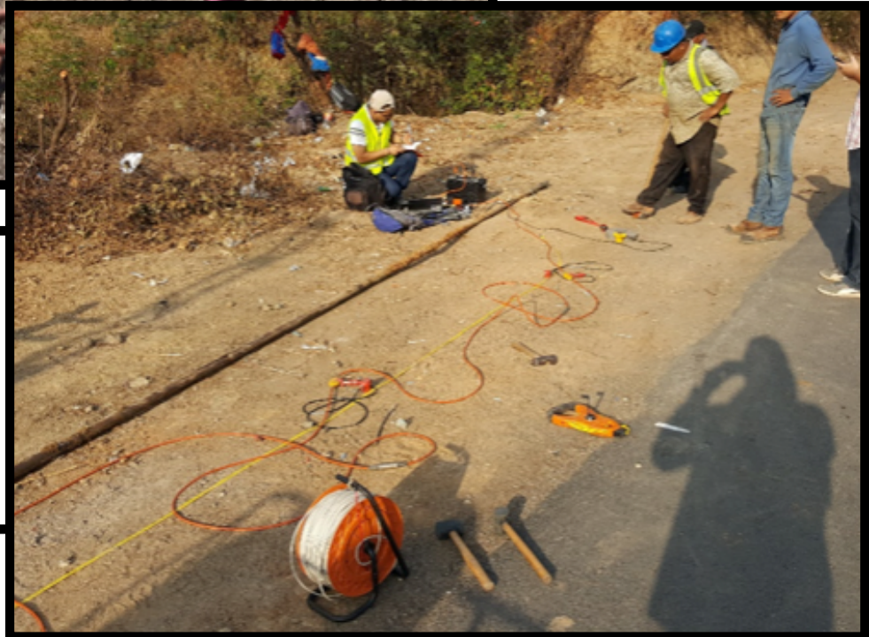
Prueba de refracción sísmica en km 36
